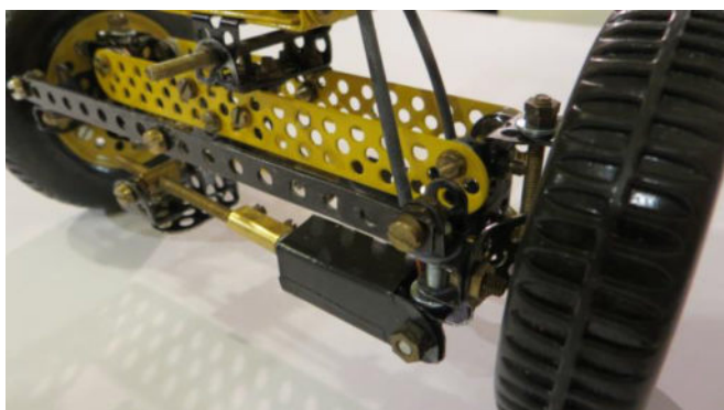
Stellmotoren für Lenkung und Sturz an der Vorderachse
