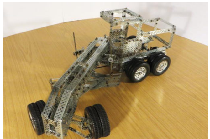
Funktionsmodell mit eingeschlagenem Knickgelenk
