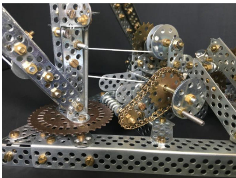
Abb. 5 Antrieb für Drehung des Mastes
