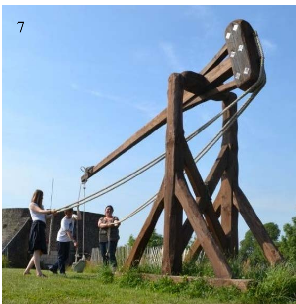
7-8. Bricole à contrepoids parallèle à la verge reconstituée à la citadelle de Montreuil-sur-Mer (62).
