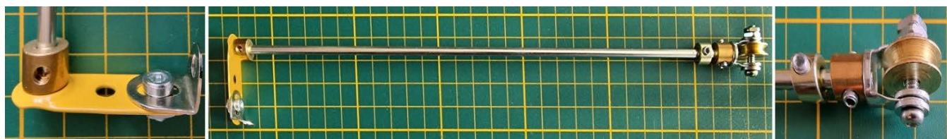
Fig. 8. La tringle de 30 cm, sa poulie à droite et son bras de manivelle à gauche
