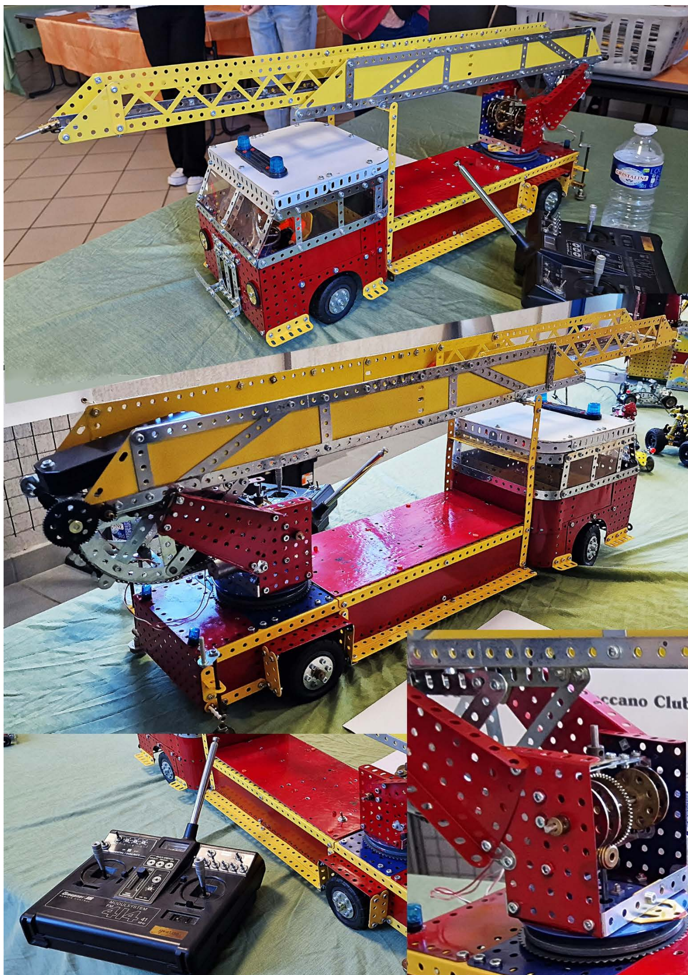
Le camion de la boîte 9 amélioré avec radiocommande des divers mouvements : direction, marche avant et marche arrière, rotation de l'échelle et développement pour faire monter la lance d'incendie inclinable.
