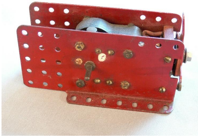
Umschaltblock (Front) verschraubt. Bürstenträger mit je zwei Schrauben befestigt
