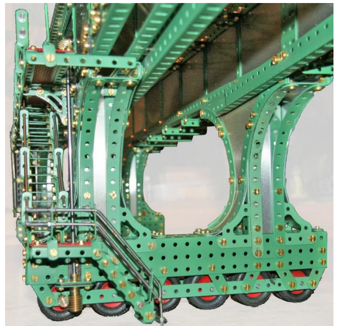
Fig. 5: Rückseitiges Brückenportal mit Fahrwerk und Treppenaufgang zum linksseitigen Laufsteg.
