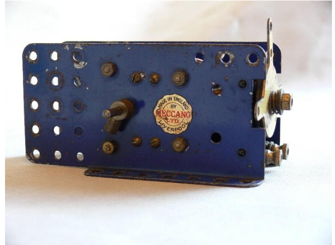
Umschaltblock mit Nasen statt Schrauben; Bohrungen zwischen Feldwicklungsbolzen und Umschalter sind für die Anschlüsse des E20A
