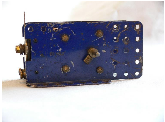
Betriebsspannung 20 V, Grease Cups an Ankerlager
