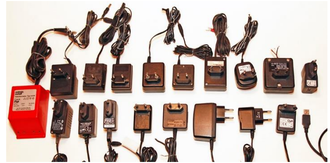
Fig. 8: Märklin 12 V MBK-Transformator (rot) und Steckernetzteile verschiedenster Bauart.
