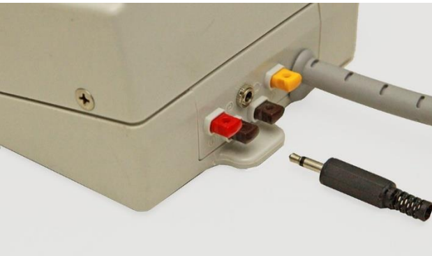
Fig. 7: Transformer Nr. 6647 mit Klinkenbuche
