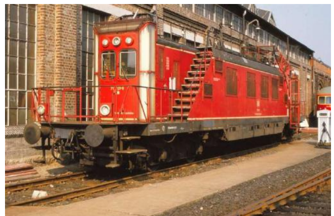
Tunneluntersuchungsfahrzeug im AW Limburg
