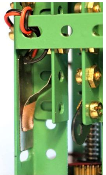
Schleifkontakt am Teleskop für Warnlampen
