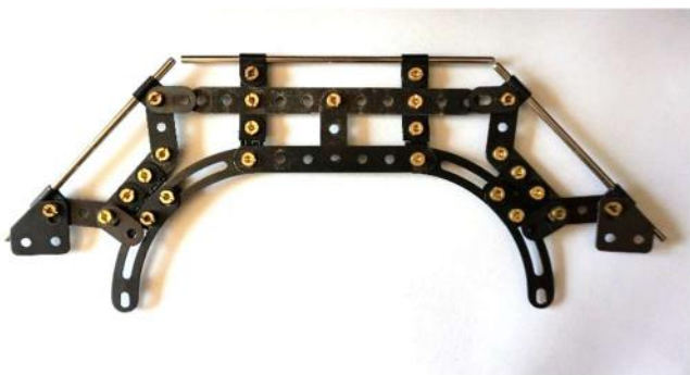
Umlegbare Profillehre auf dem Dach zur Lichtraumprüfung
