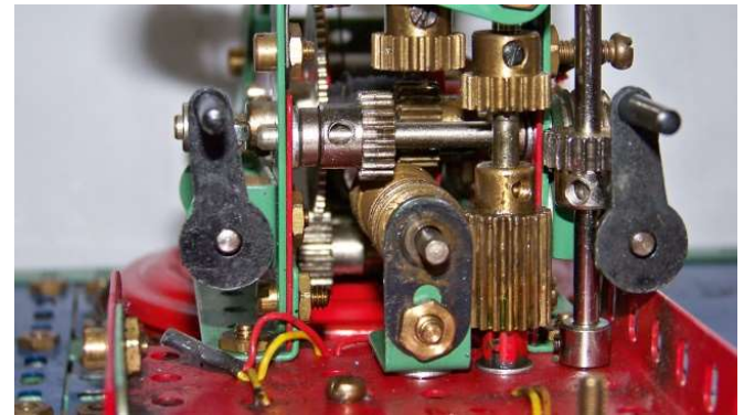
Bild 8: Draufsicht Hauptantriebswelle – Lager auf der Motorseite; zur besseren Darstellung sind Motor und Kettenrad entfernt
