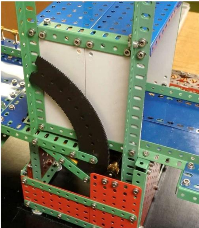
Fig 18 Ritzel und Zahnsektoren in der Wand versteckt
