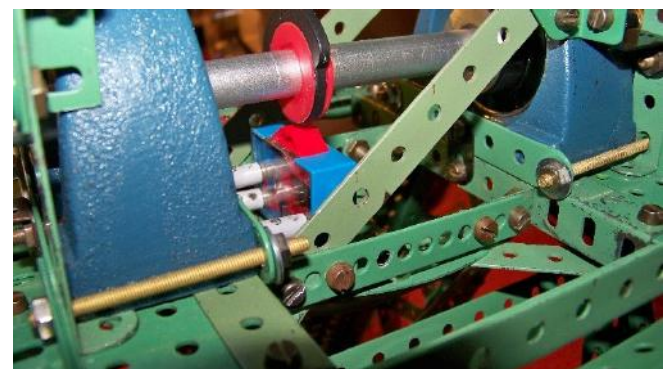
Abb. 18: Wellennocken und Märklin plus Schalter
