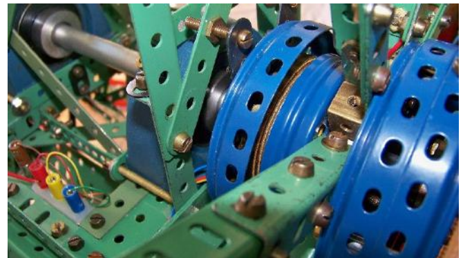
Abb. 14: gespiegelte Schleifringe; verschraubtes „Sandwich“ Runde Platte #10365 – Arme – Runde Platte #10395
