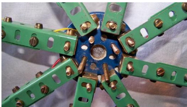
Abb. 13a: Radspinnenbefestigung im Zentrum
