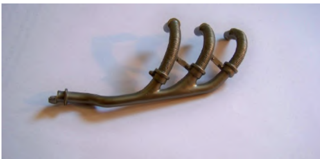
Abb. 7: Auspuffanlage des Kunststoffmodellautos. Mehrfachkrümmungen und Drei-in-Eins-Führung der Auspuffrohre waren im gewünschten Maßstab mit Baukastenteilen so gut wie gar nicht zu bauen.
