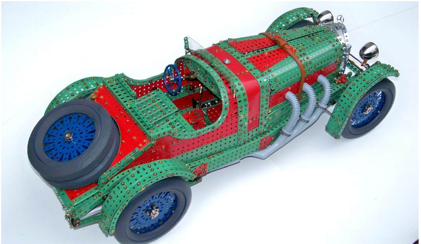
Abb. 21: Am Übergang vom Rahmen zum Motorgehäuse sind beidseitig je zwei Erector-Teile (Nr. nicht bekannt) verbaut (vergl. auch Abb. 9 + 23); durch ihre Keilform gleichen sie ideal den Winkel aus, der sich durch den Anstieg des Rahmens hin zur Vorderachse und
