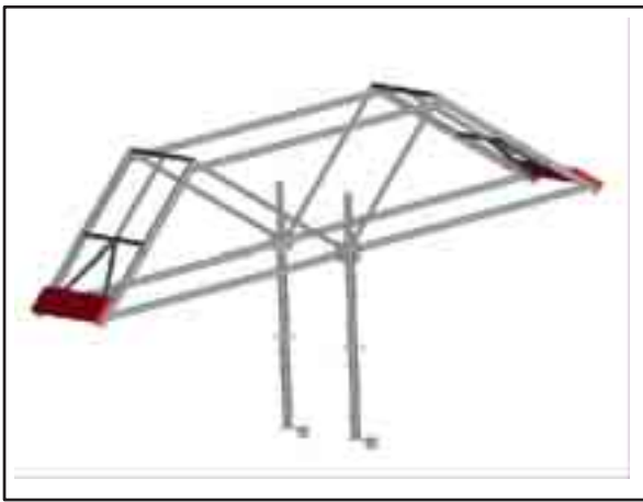
Schéma du garde-corps pour recette de matériaux. Repose sur deux étriers de départ (réf. KETR).
