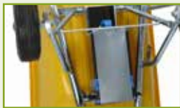
Chassis renforcé avec protection de batterie
