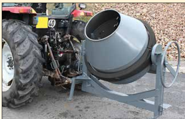
Fixation sur les 3 points du tracteur, entraînement par cardan
