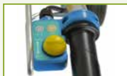
le régulateur de vitesse (joystick) permet de contrôler précisément la vitesse de la brouette en marche avant et arrière
