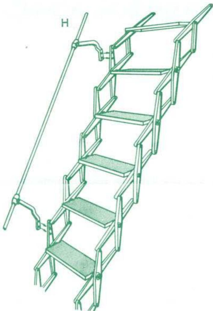
6. **RAMPE D'ACCES** : si vous avez commandé cet accessoire, procédez à la mise en place à l'aide des vis et écrous livrés en fixant les supports à manchons aux trous prévus dans les croisillons comme illustré en « H ». Le manchon du support destiné à la base comporte une vis de blocage qu'il suffira de serrer après avoir introduit le tube de rampe dans les supports jusqu'à hauteur voulue.
