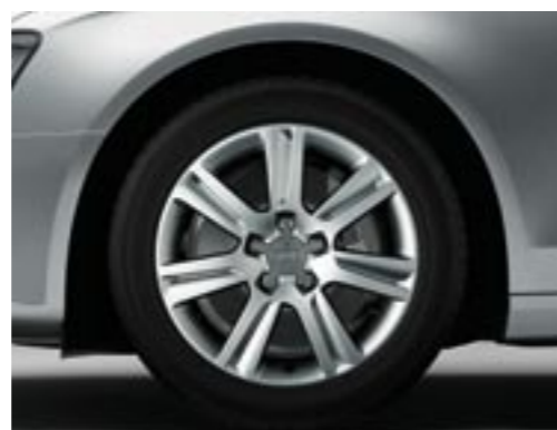
Jantes en aluminium coulé style 7 branches structurées, 7,5 J x 17 avec pneus 225/50 R 17
