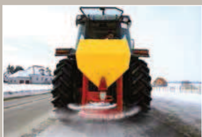
Largeur de travail réglable de 1 à 7 mètres
