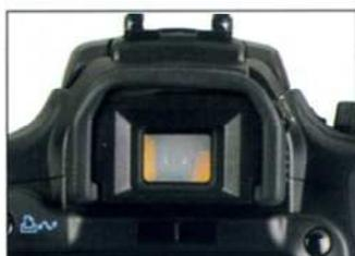
Les deux capteurs situés sous le viseur permettent d'éteindre l'écran LCD dès que le photographe approche de l'œil.
