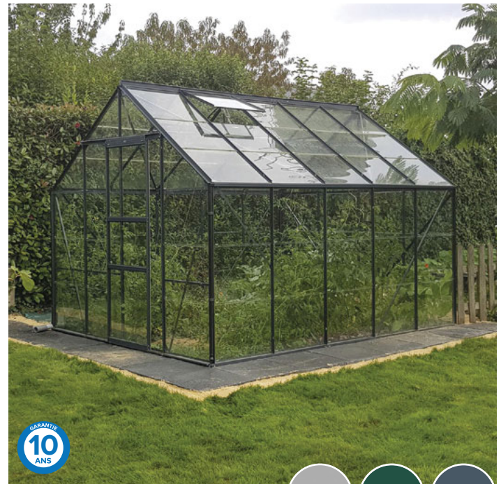
Serre Carvi Structure en aluminium et base en acier. Panneaux en verre trempé ép. 3 mm. Dim. ext. hors tout l. 2,57 x P. 3,21 x H. 2,36 m. Dim. int. l. 2,55 x P. 3,17 x H. 2,36 m. Dim. de la base l. 2,55 x P. 3,17 m. Gris acier, vert ou anthracite. Réf. 3438617951397/886958/886972
