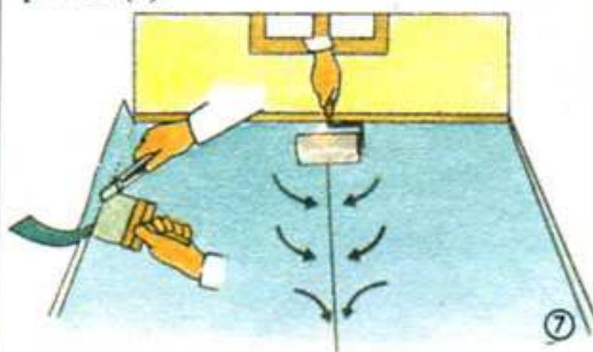
Pour une moquette à motif, **raccorder** les motifs, et procéder comme ci-dessus. LA MOQUETTE COLLEE EST IRRECUPERABLE. IL EXISTE UN PRODUIT FIXATEUR DE MOQUETTE QUI S'APPLIQUE AU ROULEAU ET PERMET LE DECOLLAGE DE LA MOQUETTE.
