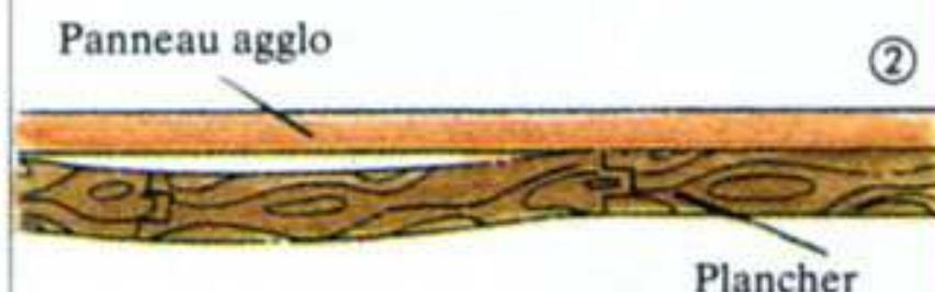
Si les déformations sont supérieures à plus de 5 à 6 mm **comblé** les cavités avec du ciment de ragréage (3).
