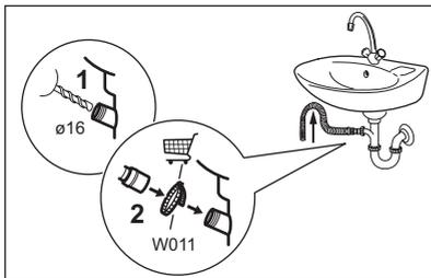
Raccordez le tuyau de vidange au siphon et serrez-le avec une attache. Veillez à ce que le tuyau de vidange
