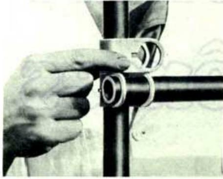
Placez le raccord en cavalier sur l'un des tubes.
