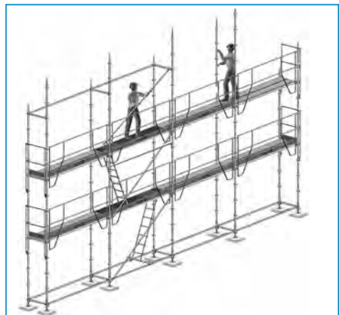
8 Le montage de l'étage 2 continue avec les montants, diagonales et plinthes.
