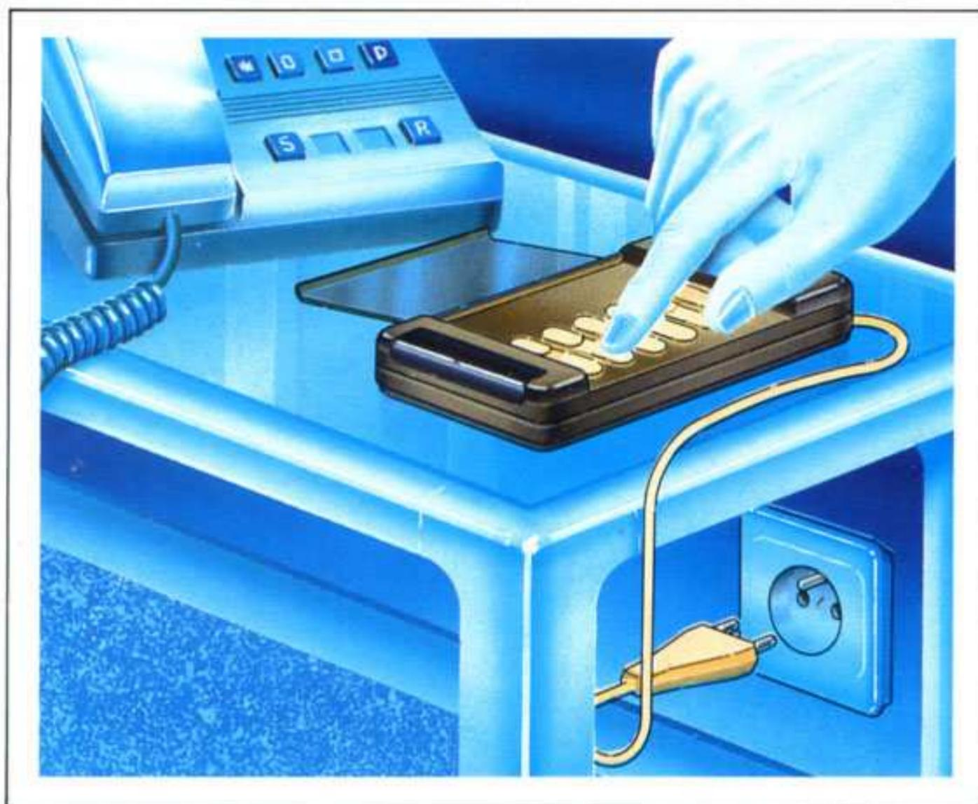
Véritable centrale de pilotage, l'émetteur de table transmet des signaux courant porteur codés aux différents récepteurs. L'émetteur peut commander jusqu'à six récepteurs codés différemment. Possibilité de coupure générale de tous les récepteurs.
