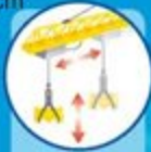
Le palan s'oriente de haut en bas et d'avant en arrière
