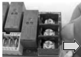
Clipper le connecteur de puissance sur la carte 400 V
