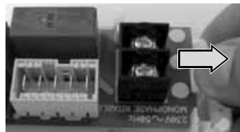
Déclipper puis retirer la carte 230 V
