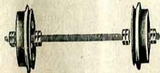
III. Wagenachse od. Maschinenwelle, die sich nicht in den Lagern dreht, wo die Räder zwischen je 2 Gegenmuttern festgestellt sind. Die Räder drehen sich auf der Achse oder Welle.
