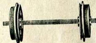
IV. Wagenachse od. Maschinenwelle mit fest daran verschraubten Rädern. Die Räder drehen sich mit der Achse oder Welle.
