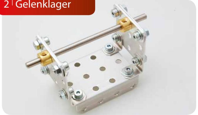
Die Gelenklager werden erst nur ganz locker an den Seitenwänden befestigt. Anschliessend wird eine Hilfs-Achse durch die Lager gesteckt, um die Bauteile funktionell zu zentrieren. Wenn die Lager ausgerichtet sind, können alle Schrauben fest angezogen werden. Die Hilfs-Achse ist nun drehbar und kann bei Bedarf wieder entfernt werden.
