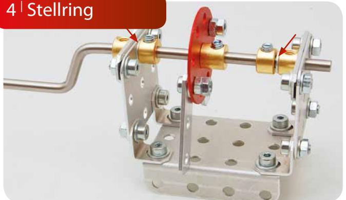
Die zwei Stellinge verhindern, dass die Achse aus den Lagern rutscht. Die zwei Unterlagscheiben lassen die Stellinge leichter aneinander gleiten. Etwas Spiel in der Grössenordnung von einem halben Millimeter verbessert die Leichtigängigkeit.
