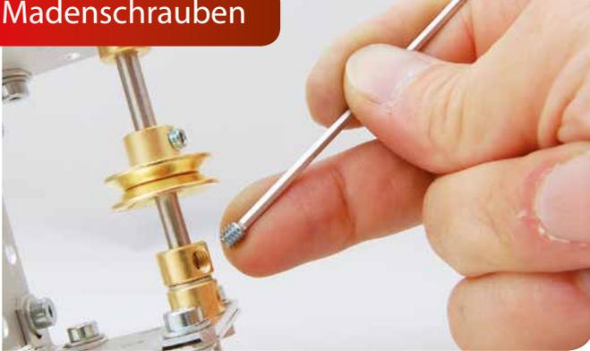
Mit der Zeit entwickelt jeder seine eigenen «Tricks», um knifflige Montagearbeiten in den Griff zu bekommen. Hier ein Vorschlag wie man Madenschrauben einfacher einsetzen kann.
