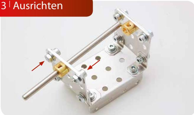
Manchmal ist es im Nachhinein nötig, die Lager aufeinander auszurichten. Entweder löst man ein paar Schrauben und richtet die Lager parallel zueinander aus oder man drückt seitlich an der Stange und verbiegt die Halterungsplatten der Lager etwas.
