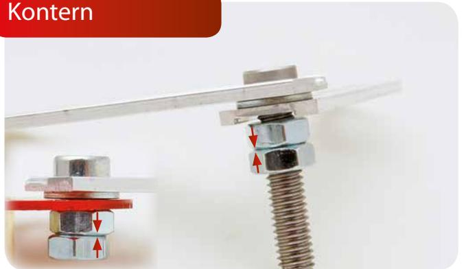
Zieht man zwei Muttern gegeneinander an, sind sie fest an einer Stelle auf dem Schraubengewinde fixiert. Auf diese Weise kann eine Verbindung beweglich bleiben, ohne sich zu lösen. Die Unterlagsscheibe verringert die Reibung zwischen den Teilen.
